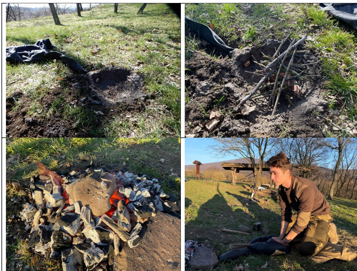
Príloha č. 6 Postup stavby vyhne a zohrievania téglika. Vľavo hore – kruhová jama s vloženým nákončím dýchacieho mechu tesne po výmaze. Vpravo hore – vyhňa pripravená na rozloženie ohňa s vloženým drevom. Vľavo dole – priebeh zohrievania téglika vo vyhni za použitia dreveného uhlia a stáleho dúchania vzduchu pomocou koženého mechu. Vpravo dole – proces dúchania.
